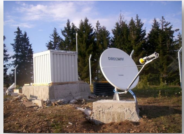
Şekil 3.1.1. Türkiye Ulusal Deprem İzleme istasyonlarının kurulumuna bir örnek
